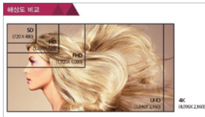
그림 4 ____ SD와 HD, Full HD의 차이. 역시 TV를 만드는 회사 블로그답게 설명이 잘 나와 있다. (출처: LG디스플레이 공식 기업블로그, blog.lgdisplay.com) SD급은 720x480의 해상도로 픽셀 수는 345,600개이다. FHD급의 경우 1,920x1,080의 해상도로 픽셀수는 2,073,600개로 SD급과 6배정도 차이가 난다. 더 크고 넓고 선명한 영상을 볼 수 있다.
