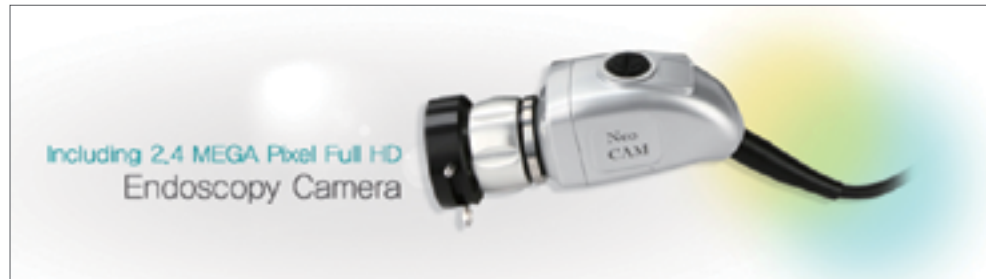
그림 9 카메라 헤드 앞의 커플링 렌즈(coupling lens)는 조리개와 초점을 맞추는 역할을 한다. 오토 포커스는 지원하지 않는다. 실링 처리가 나뉘 꼼꼼히 되어 있어 생활방수 정도 즉, TUR 중 물이 튀는 정도는 괜찮은 것 같다. 제품 소개는 water proof라고 되어있으나, 물에 담가볼 배정은 없어서 완전 방수인지는 모르겠다. 소독이 된 비닐 포장(sani sleeve)을 쓰면 불편하기도 하고 습기가 차기 때문에 선호하지 않는다. 우리 병원의 경우 카메라 헤드를 통째로 EO gas 소독을 한 후 sleeve 없이 직접 쓴다. 그래서 카메라 헤드를 2개 더 구입했다.
