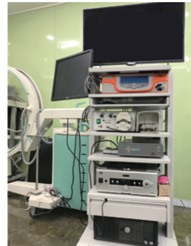
그림 11 우리 병원 수술실에 설치된 Video system cart. 제일 위부터 (1)30만원이 채 안되는 국산 32인치 모니터. 솔직히 병원에 보유 중인 21인치 의료용 LCD 모니터에 비해 나쁜 점을 잘 모르겠다. (2)너무나도 잘 아시는 ACM시절 마지막 Bipolar System. 사용 빈도가 높진 않지만 구입 7년째 내부 기판의 소트로 추정되는 고장이 발생했다. 다행히 회사를 인수한 Olympus 측에서 AS를 도맡아 잘 처리는 했는데, 국내 수리가 불가능하여 미국에 다녀오느라 3개월 정도 기간이 소요되었다. (3)Lumenis morcellator, 홀랩 수술 후 분리된 전립선 선종(adenoma)을 분쇄하여 몸 밖으로 흡인하는 장비, 특별한 고장은 없었다. (4)오늘의 주인공. 국산 FHD급 비디오 시스템. "솔만하다"라는 말이 가장 적당한 표현 같다. 1년 넘게 써보니 가격대 성능을 따진다면 괜찮은 선택 중 하나라는 생각이다. (5)MGB Xenon light source, 300watt 급으로 spare halogen lamp가 내장된 것이 매력적이었다. 쏘 일은 없었다. Xenon 램프 수명이 아직 300시간 이상 남아서 아직 쓰고 있는 중이다. 개인적으로 시연을 해보니 Halogen보다는 180watt Xenon이 좋다. 180watt Xenon보다 LED light source가 확실히 우수한데, 300watt Xenon을 보유하신 분들은 굳이 LED로 교체하실 필요는 없을 것 같다. (6)PACS로 연결되는 Gateway PC. 다른 작업을 안하다 보니 10년전 사양의 Dell 컴퓨터임에도 아직 쓸만하다. 올해 초 비디오카드 노후로 해당 부품만 교체했고 특별한 고장은 없었다.
