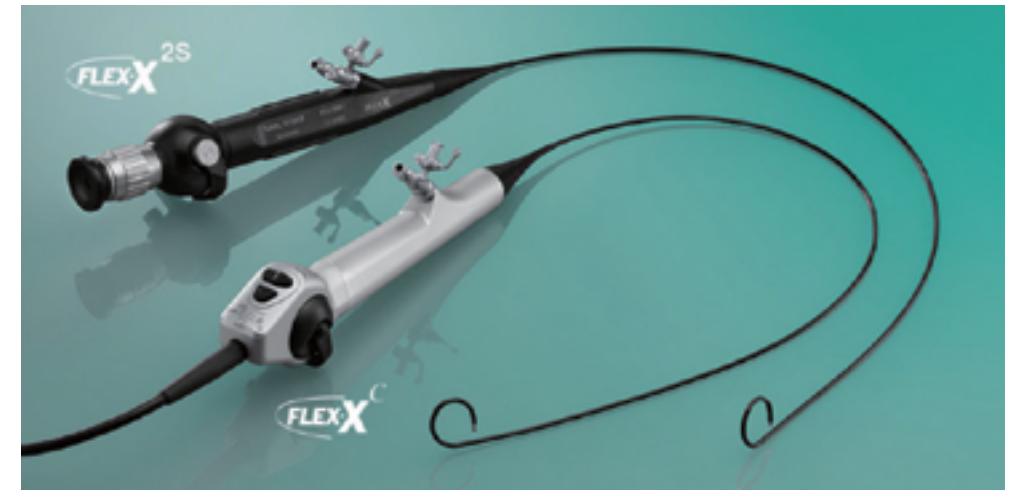
그림 6 ____ 2009년 개원 당시에는 각 업체에서 HD급 장비가 소위 말하는 “종병급” 장비였고, 주요 판매 품목이었다. 또한 HD급 이상의 digital scope(내시경에 카메라 센서가 내장되어 있는 제품)을 출시하며 기술력을 뽐내던 시기였다. 사진은 Karl Storz사의 Flexible ureterorenoscope 사진. 위쪽(FLEX-X2S)이 카메라 헤드가 필요한 optical scope이고, 아래쪽(FLEX-XC)이 내시경 끝에 FHD급의 센서(촬영소자)가 내장되어 별도의 카메라가 필요 없는 digital scope이다. 가격은 digital scope이 몹시 더 비싸다. 물론 우리 병원에 저런 비싼 장비는 없다.
