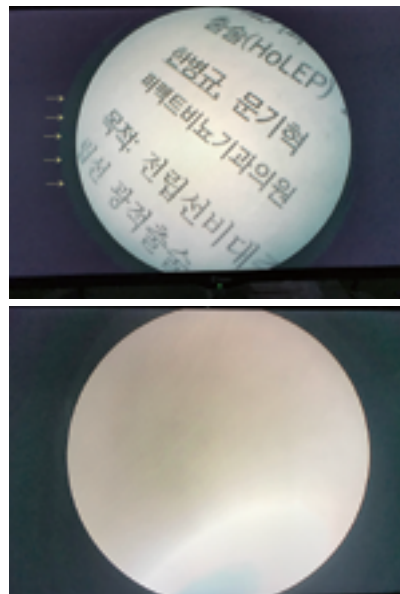
그림 10 우리 병원에서 구입한 국산 FHD video system의 모니터를 촬영한 사진. 글씨가 있는 사진을 보면 동그란 내시경 시야 주변으로 달무리처럼 동계진 원형의 노이즈가 보인다(화살표). 밝은 화면에서 두드러지고 움직임이 크면 크기도 변하며 일렁인다. 두번째 사진(글씨없는 사진)은 telescope과 camera head의 coupling lens를 손으로 잡고 밀착시킨 경우로 달무리 같은 노이즈가 확연히 줄었다. 제조사에서는 coupling lens의 빛샘으로 인한 현상으로 진단을 내렸지만 해결은 안됐다. 다행히 내시경 시야 바깥쪽에만 존재하므로 적응하고 나니 크게 불편하지는 않다. 물론 신경은 쓰인다. 내가 발견한 가장 큰 단점이다.
